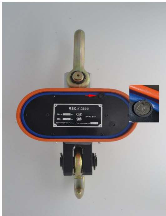
Рисунок 3 – Схема пломбировки корпуса весов от несанкционированного доступа
