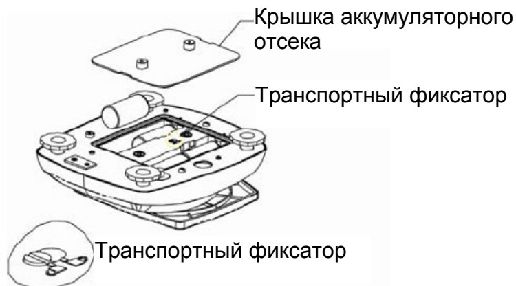
Рис. 2-2. Установка элементов питания
