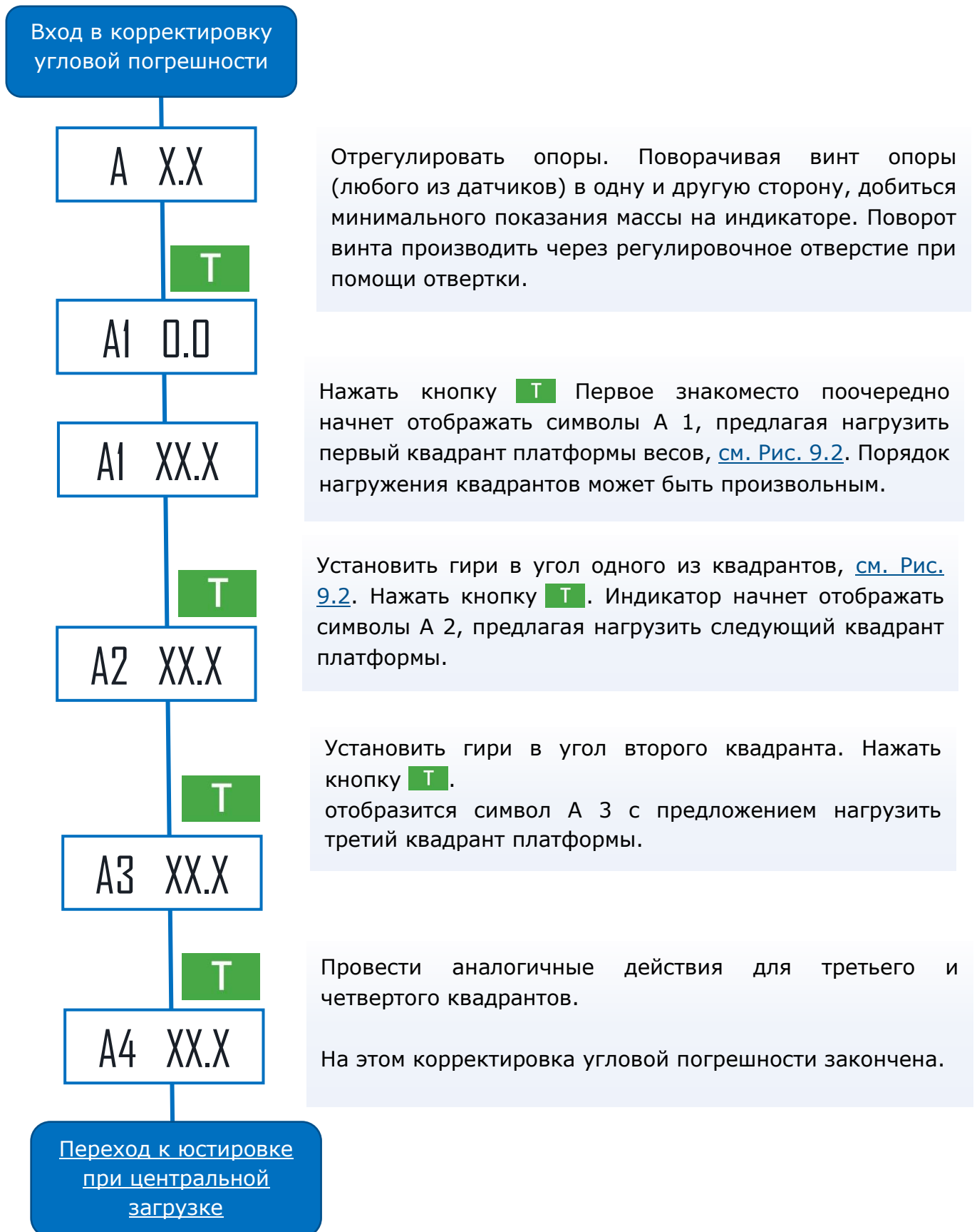
Рис. 9.3. Последовательность корректировки угловых погрешностей модулей 4D.
