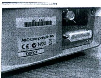
Рисунок 2 – Схема пломбировки весов от несанкционированного доступа
